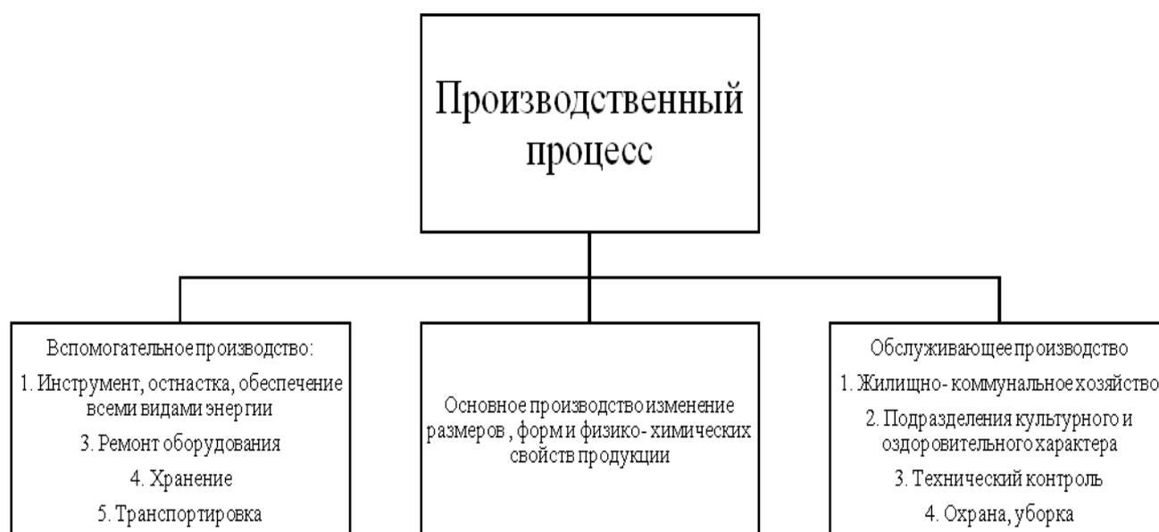
Рисунок 1 - Структура производственного процесса
